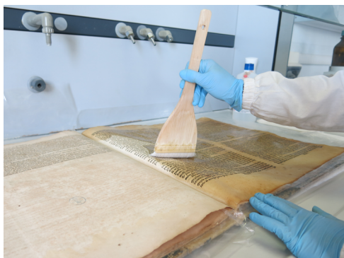
Fig. 24 | Applicazione della soluzione TBAB e propionato di calcio sotto cappa aspirante
