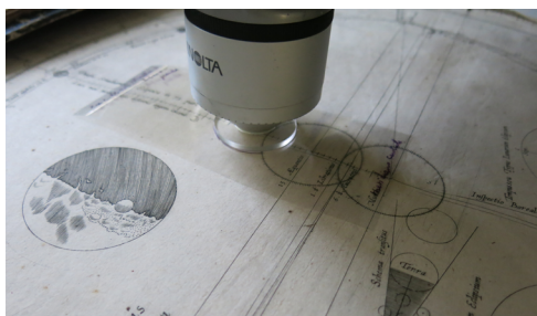
Fig. 25 | Misurazioni colorimetriche dopo il trattamento
