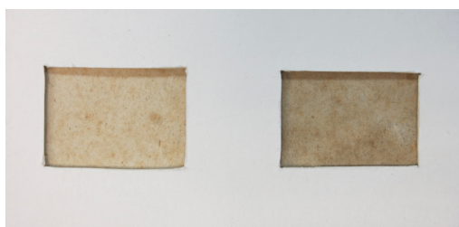
Fig. 23 || Tassello di pulitura eseguito con gomma in lattice vulcanizzato
